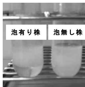
図3 水-ベンゼン混濁を用いた簡易識別
