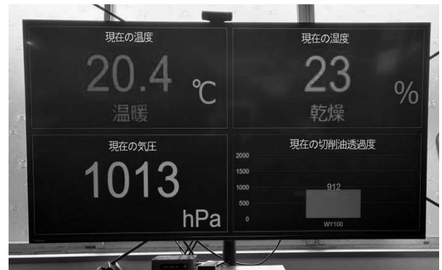
図 6 現場事務所の可視化モニター (温度、湿度、気圧、切削油)
