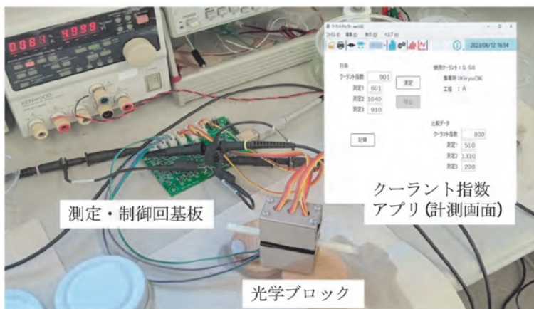
図1 試作したクーラントモニター装置
