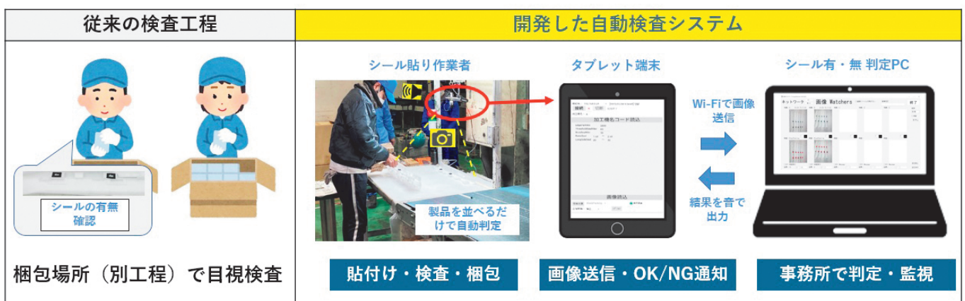
図1 従来の検査方法と、新規自動検査システム
