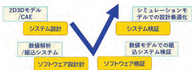
図2 モデルベース開発プロセス
