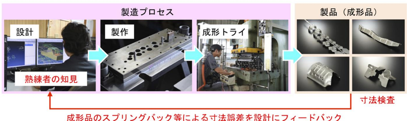
図1 金型製作プロセスにおける熟練者の技能に依存する工程
