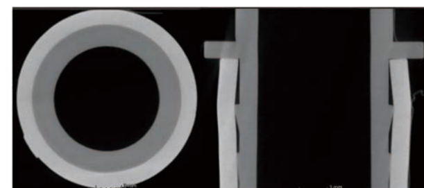
X線CTによる亀裂の評価(上:試験後, 下:試験前)
