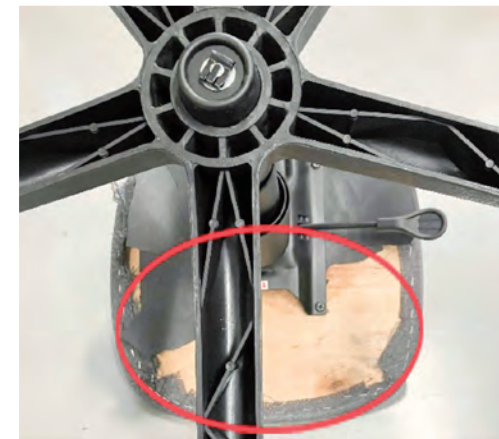
図2 経年劣化で破損した椅子の裏側
