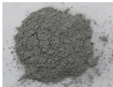
写真2 裁断工程で発生する切粉
