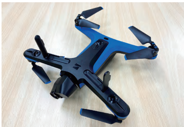
屋内対応自動監視ドローンシステム
