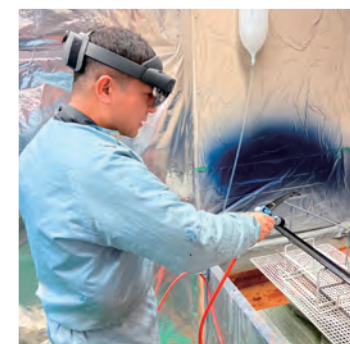
図2 MRシステムをした塗装工程
