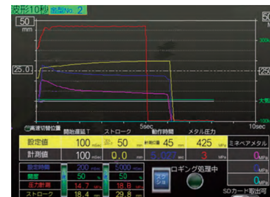
図2 金型内圧測定
