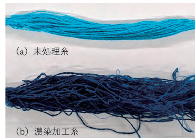
カチオン染料で染色した濃染加工糸
