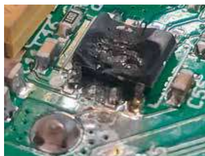
試験により破損した基板
