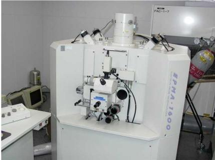
波長分散型電子線マイクロアナライザー
