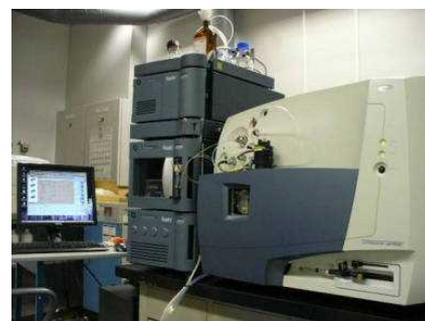
大気圧直接イオン化質量分析装置
