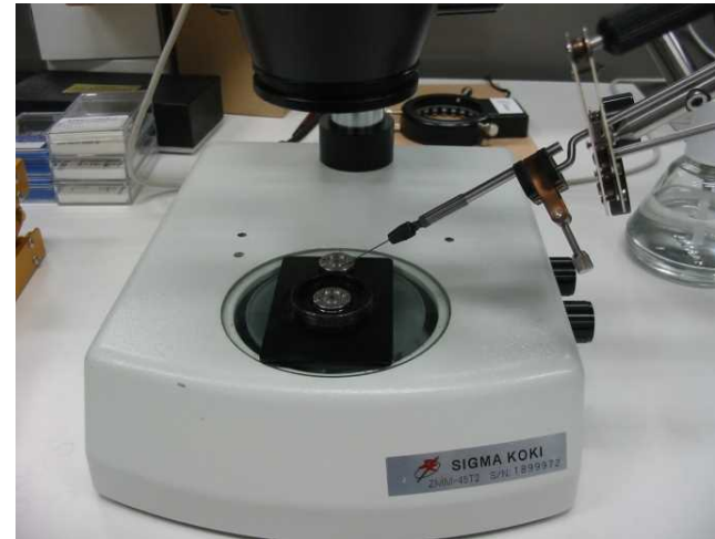
マイクロサンプリングツール 顕微鏡下で試料を観察しながら、 微小異物の採取、掘り出し、カットなどを行う。
