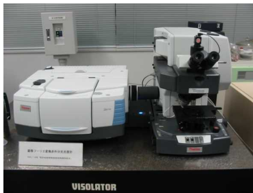
サーモフィッシャー サイエンティフィック社 FTIR iS50 + 赤外顕微鏡 Continuum
