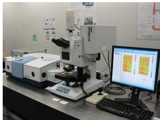
ブルカー・オプティクス社 FTIR Vertex70 + 赤外顕微鏡 Hyperion3000
