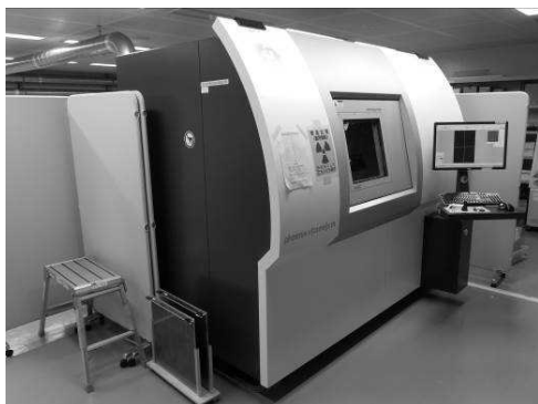
図 1 高分解能計測用 X 線 CT システム
