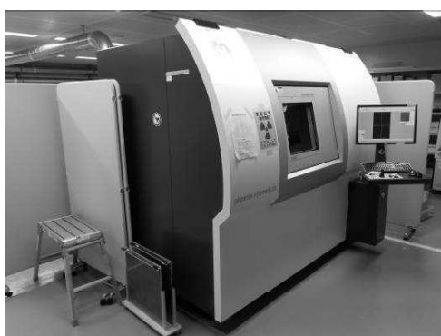
図 1 高分解能計測用 X 線 CT システム
