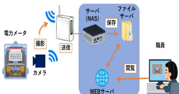
図1 システムフローの概要
