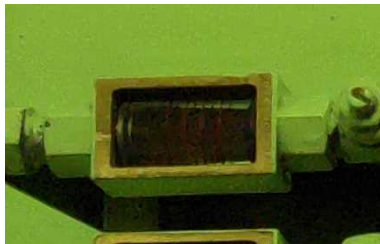
図 10 ノイズにより指示値が不鮮明な画像
