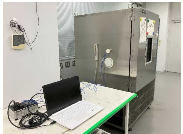
図 1 実験システム(データロガ、温度取得用ノートPC、恒温恒湿器)
