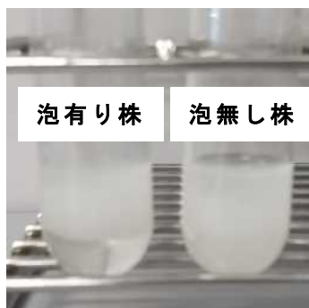
図2 水-ベンゼン混濁を用いた簡易識別
