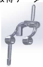
図11 複雑形状部品のソリッドデータ
