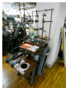
図1 稼働中の管巻機
