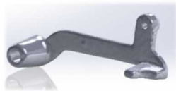
図11 複雑形状部品のソリッドデータ
