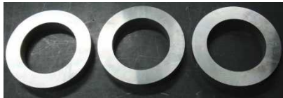
(a)First_cut(b)Second_Cut(c)Third_cut 図9 円筒穴形状の加工をしたサンプル
