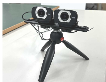
図 3 Web カメラ 2 台によるステレオカメラ
