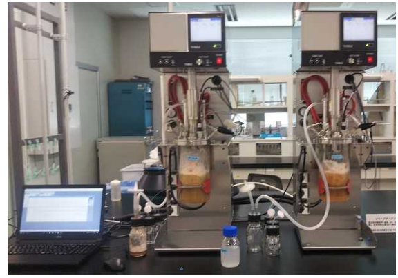
図4 ジャーファーマンターの外観
