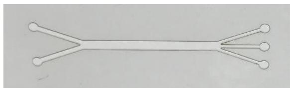
図6 機能性フィルムのレーザー加工による流路
