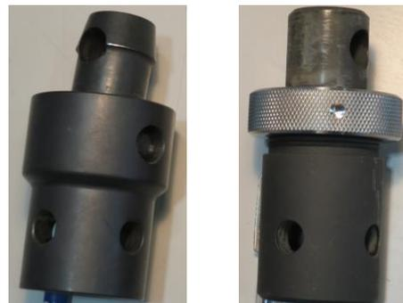
(a) 自在継手 (b) 固定軸継手
