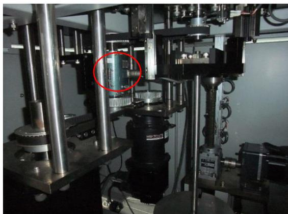
図2 駆動軸部（囲み部：トルクメータ）
