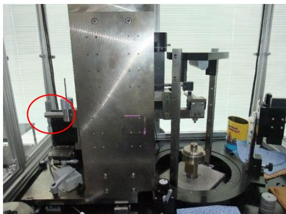
図1 試験台（囲み部：ロードセル）
