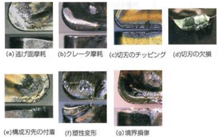
図2 切削工具の損傷形態
