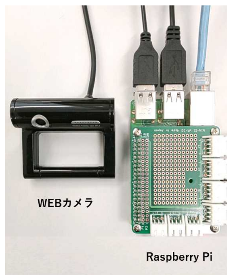
図2 IoTツール (Raspberry PiとWEBカメラ)
