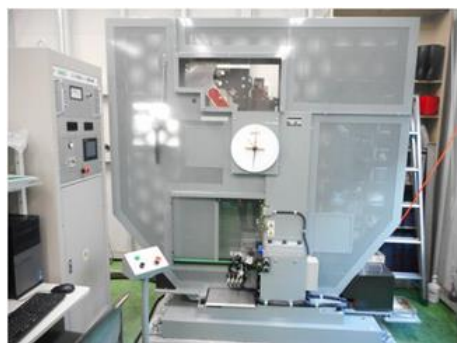
図3 計装化シャルピー衝撃試験機 (井上熱処理工業(株) 提供)
