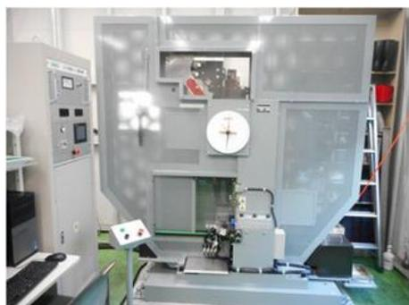
図3 計装化シャルピー衝撃試験機
