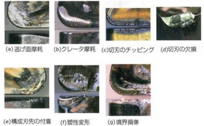
図2 切削工具の損傷形態
